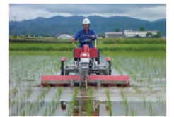
省力的な有機栽培を可能とする 高能率水田用除草機
