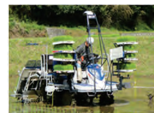
化学肥料の施肥量を減少させる 土壌センサ付可変施肥田植機
