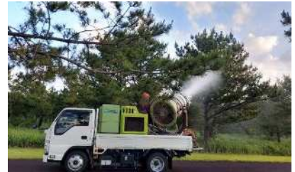
スパウターによる地上散布
