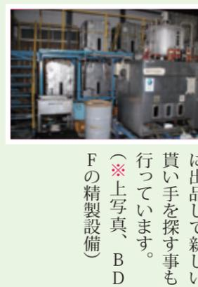
このように、ほとんどのごみが点検・分別されて業者に引き渡されませんが、廃食油は、施設内で加工され、燃料のバイオディーゼル（BDF）として生まれ変わります。施設内で稼働しているフォークリフトやごみ収集車は、これを燃料にして動いています。また、資源化するだけでなく、粗大ごみでまだ使えそうなものは、月に一度開かれる『掘り出し物市』に出品して新しい貰い手を探す事も行っています。（※上写真、BDFの精製設備）
