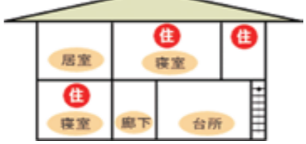
寝室のみの設置となるため、設置個数は3個
