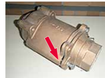
凍結により破損した圧力調整弁（矢印部分）
