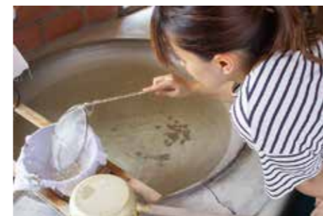
ポイントは温度管理。火が強すぎると石灰分が多くなり雑味がでるそうです。
